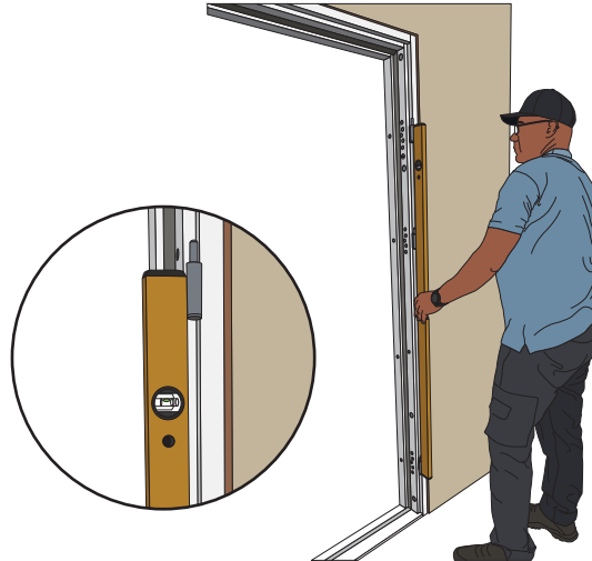
8 ŽINGSNIS. Dar kartą patikrinkite įtvirtintą durų staktą naudodami gulsčiuoką. Įsitikinkite, kad visi vyriai yra vienoje ašyje.
