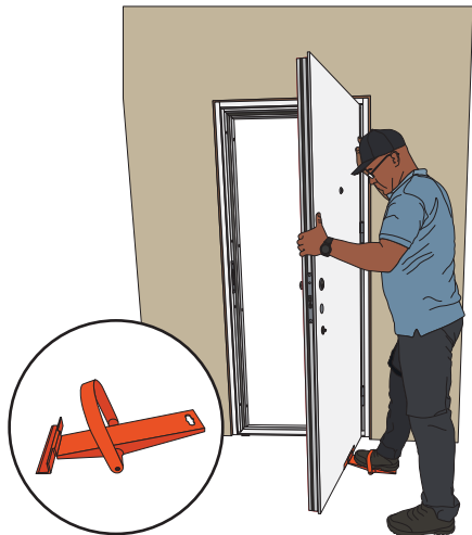
7 ŽINGSNIS. Pritvirtinkite durų staktą (vyrių pusėje) prie sienos varžtais.
